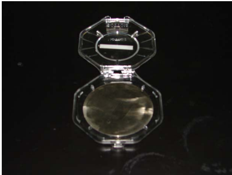
熱壓用的母模,此模仁圖案為微透鏡陣列
