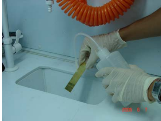
圖、電鑄完成後再將被鍍物以丙酮清洗一次。
